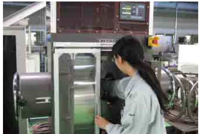
研究開発用成型装置による磁石の試作
