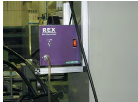
研削装置に取り付けられたオゾン発生装置
