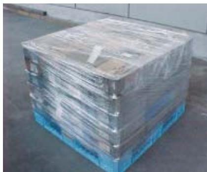
【従来】 ストレッチフィルム(ポリエチレン製)による荷崩れ防止。 1パレット当たり5～6周巻き、約25m使用。
