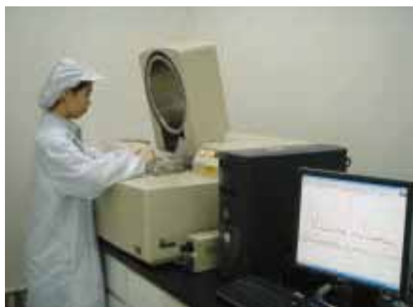
XRF(蛍光X線分析装置)を用いた受入検査の導入(タイ・バンパイン工場)
