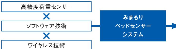
少子高齢化による人手不足の中、高精度荷重センサー、ソフトウェア、ワイヤレスを組み合わせ、ベッド脚に設置するだけで、1つのシステムによってベッド上の人々の位置・体動・参考体重などのバイタル情報を取得。利用者の快適・安全、ご家族の安心、介護従事者の負担軽減を実現します。
