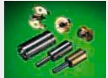
シャフトに2本のボール溝を持ち、通常、2個使用するボールベアリングの内輪とシャフトを一体化した構造の特殊ベアリングで、ビデオカメラのシリンダーなどに使用されています。シャフトにボールベアリングを2個取り付けただけの場合に比べて回転精度が高くなります。
