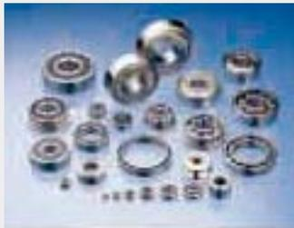
外輪、内輪、ボール、リテーナー(ボール保持器)、シールド(フタ)、スナップリング(バネ)により構成されています。特に高度な回転性能が必要とされる精密モーターなどの回転軸を受ける部分に組み込まれており、一般的にはモーター1台に2個使用されます。ミネベアは外径22mm以下のサイズを中心に詳細仕様まで含めると8,500種類以上生産しています。
