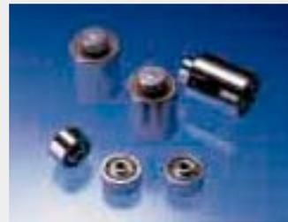
HDD用スピンドルモーター向けにミネベアが開発した高精度ベアリングです。外輪の内側に2本、シャフトとシャフトに取り付けた内輪の外側に各々1本のボール溝を付け、2個のベアリングを一体化した構造となっており、ミスアライメント防止やNRRO(非線返し性振れ)低減の点で格段に優れていると同時に、組み込むモーターの小型化を可能にしています。
