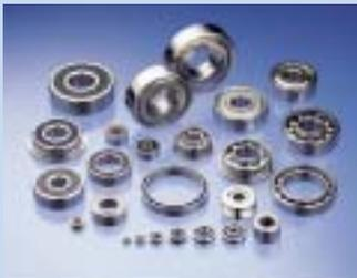
外輪、内輪、ボール、リテーナ(ボール保持器)、シールド(フタ)、スナップリング(バネ)により構成されています。特に高度な回転性能が必要とされる精密モーターなどの回転軸を受ける部分に組み込まれており、一般的にはモーター1台に2個使用されます。ミネベアは外径22mm以下のサイズを中心に詳細仕様まで含めると8,500種類以上生産しています。
