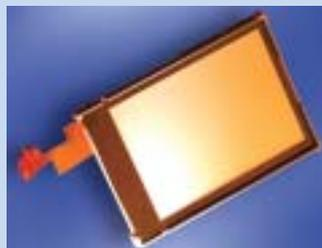
携帯電話やPDA等の高精細カラー液晶用ミネベア製ライティングデバイスは、液晶タイプにより、フロントライトとバックライトに分類されますが、どちらも白色LED光源と、マイクロオーダーのマイクロプリズムをもった透明樹脂で構成され、群を抜く高輝度と高品位を特長としています。
