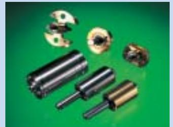
シャフトに2本のボール溝を持ち、通常、2個使用するボールベアリングの内輪とシャフトを一体化した構造の特殊ベアリングで、ビデオカメラのシリンダーなどに使用されています。シャフトにボールベアリングを2個取り付けた場合に比べて回転精度が高くなります。
