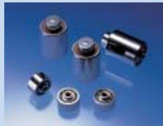
HDD用スピンドルモーター向けにミネベアが開発した高精度ベアリングです。外輪の内側に2本、シャフトとシャフトに取り付けた内輪の外側に各々1本のボール溝を付け、2個のベアリングを一体化した構造となっており、ミスアライメント防止やNRRQ(非線返し性振れ)低減の点で格段に優れていると同時に、組み込むモーターの小型化を可能にしています。
