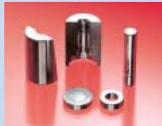
シャフトとスリーブの隙間にオイルなどの流体を満たし、シャフトが回転することにより流体に発生する圧力を利用してシャフトが浮上する構造のベアリングで、非接触構造である点から回転精度や音、耐久性の点で優れています。ミネベア製の流体軸受はボールベアリングで培われた超精密機械加工技術と大量生産技術により、量産段階での精度・品質・製造コストの点で優位性を発揮しています。
