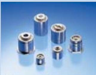
ハードディスクドライブ(HDD)の磁気ヘッドアクチュエーターの支点部分に使用される部品で、ミネベアは世界市場のトップシェアを持っています。シャフトとスリーブの間にボールベアリングを1個または2個組み込んだ構造が基本です。
