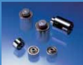
HDD用スピンドルモーター向けにミネベアが開発した高精度ベアリングです。外輪の内側に2本、シャフトとシャフトに取り付けた内輪の外側に各々1本のボール溝を付け、2個のベアリングを一体化した構造となっており、ミスアライメント防止やNRRO(非繰返し性振れ)低減の点で格段に優れていると同時に、組み込むモーターの小型化を可能にしています。
