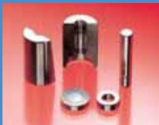
シャフトとスリーブの隙間にオイルなどの流体を満ちし、シャフトが回転することにより流体に発生する圧力を利用してシャフトが浮上する構造のベアリングで、非接触構造である点から回転精度や音、耐久性の点で優れています。ミネベア製の流体軸受はボールベアリングで培われた超精密機械加工技術と大量生産技術により、量産段階での精度・品質・製造コストの点で優位性を発揮しています。
