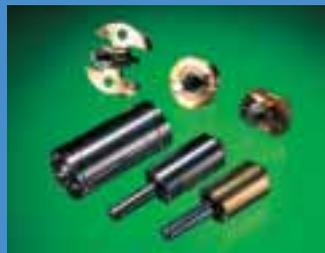
シャフトに2本のボール溝を持ち、通常、2個使用するボールベアリングの内輪とシャフトを一体化した構造の特殊ベアリングで、ビデオカメラのシリンダーなどに使用されています。シャフトにボールベアリングを2個取り付けた場合に比べて回転精度が高くなります。
