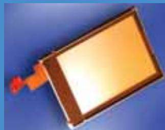
携帯電話やPDA等の高精細カラー液晶用ミネベア製ライティングデバイスは、液晶タイプにより、フロントライトとバックライトに分類されますが、どちらも白色LED光源と、ミクロンオーダーのマイクロプリズムをもった透明樹脂で構成され、群を抜く高輝度と高品位を特長としています。
