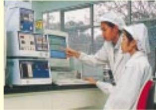
スピンドル・モーターに使用される接着剤等から発生するアウトガスの測定を行います。ハードディスクドライブとして組み上がった際に、機能障害を発生させる可能性のあるガスの検出が目的です。
