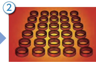
2 熱処理工程 耐荷重性能の向上や長寿命化を目的として、部品の硬度を高めるために焼き入れを行う工程。
