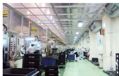
作業および通路エリアにエアコンが効くように設置されたトンネル型バーテーション
