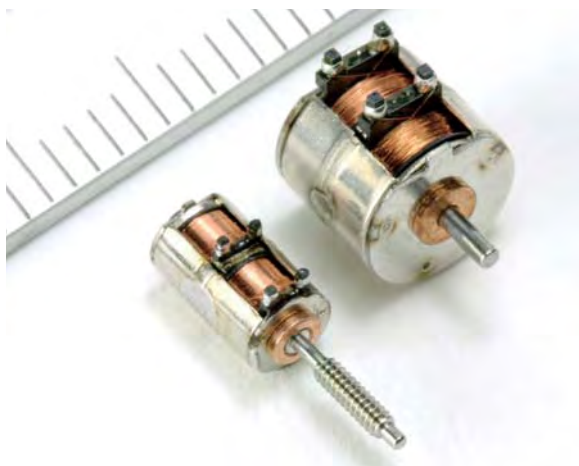
高分解能、極小PM型ステッピングモーター 製品カットモデル(左φ3mm、右φ6mm)
