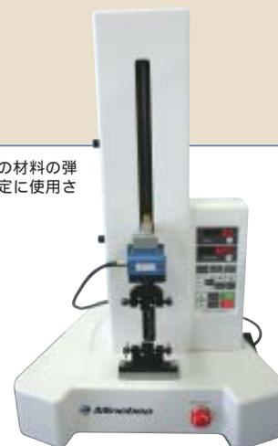
金属、プラスチック等の材料の弾性率、耐力、強度の測定に使用されます。
